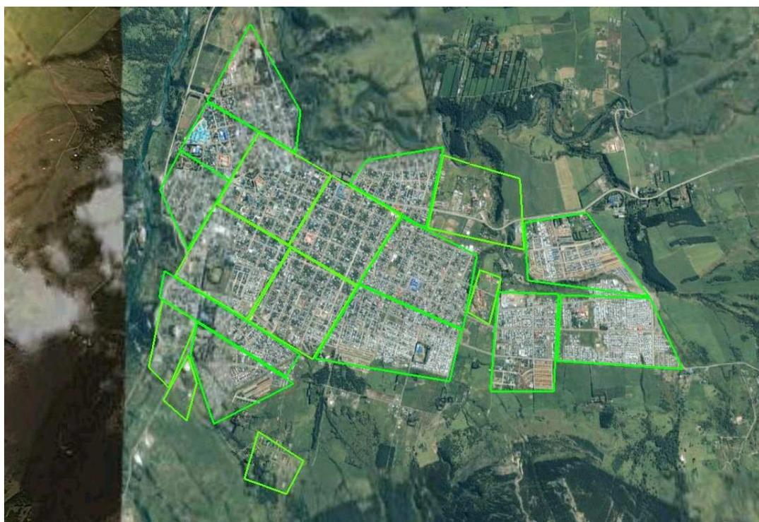
Figura 8-5: Representación esquemática de las fuentes emisoras tipo área a ser utilizadas en la aplicación de CALPUFF.
