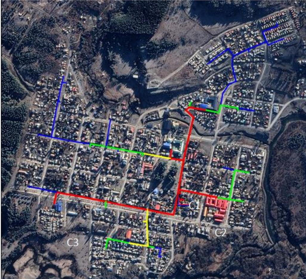
Nota: Red de tuberías primaria codificada por color para Escenario 1, 2, 3 y 4. C1= Ubicación de central térmica en base a biomasa para escenarios 1 y 2. C2= Ubicación de central térmica en base a biomasa para escenarios 3.1 y 4. C3=Ubicación de central solar térmica para escenario 3.2.
