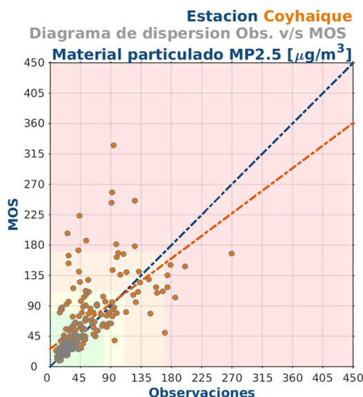
**Figura 6:** Diagrama de dispersión del Pronóstico MOS (promedios diarios) a 2 días versus las Observaciones para Material Particulado MP2.5 para la localidad de Coyhaique en la región de Aysén.
