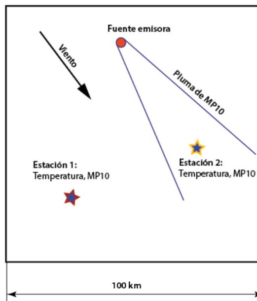
**Figura 14:** Red de monitoreo en una planicie hipotética de extensión de 100 km. La red consiste en dos estaciones de monitoreo (estrellas) que miden temperatura y MP10. Dentro de la planicie se encuentra una fuente (punto) que emite MP10 y la pluma se dirige según la dirección de viento.
