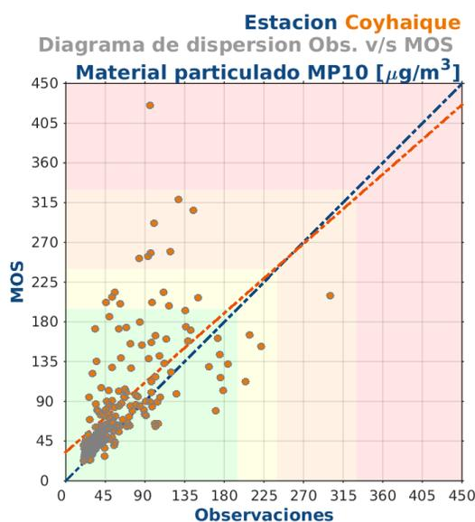
**Figura 4:** Diagrama de dispersión del Pronóstico MOS (promedios diarios) a 3 días versus las Observaciones para Material Particulado MP10 para la localidad de Coyhaique en la región de Aysén.
