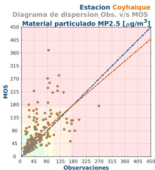
**Figura 7:** Diagrama de dispersión del Pronóstico MOS (promedios diarios) a 3 días versus las Observaciones para Material Particulado MP2.5 para la localidad de Coyhaique en la región de Aysén.
